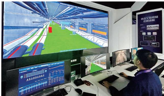
10月5日,浙江杭州供电公司员工张晨曦在电缆前哨作战室使用电缆隧道数字孪生系统远程巡检地下电力管廊。李翔翔 摄
