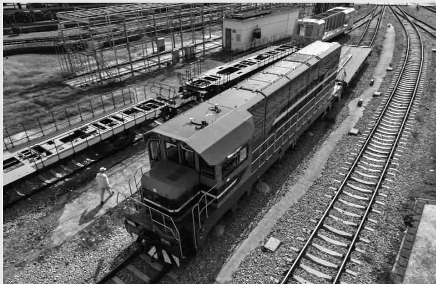
11月16日，我国首台新造大功率纯电新能源调车机车在湖南株洲中车株机公司下线。这台机车最大牵引功率1500kW，能满足冶金、港口、电力、石化、矿山等行业内部的铁路运输需求，具有绿色低碳、经济适用、智能先进等特点。
