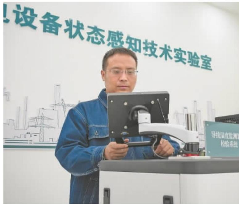
张广东在输变电设备状态感知实验室开展输电线路温度感知装置校验试验。
