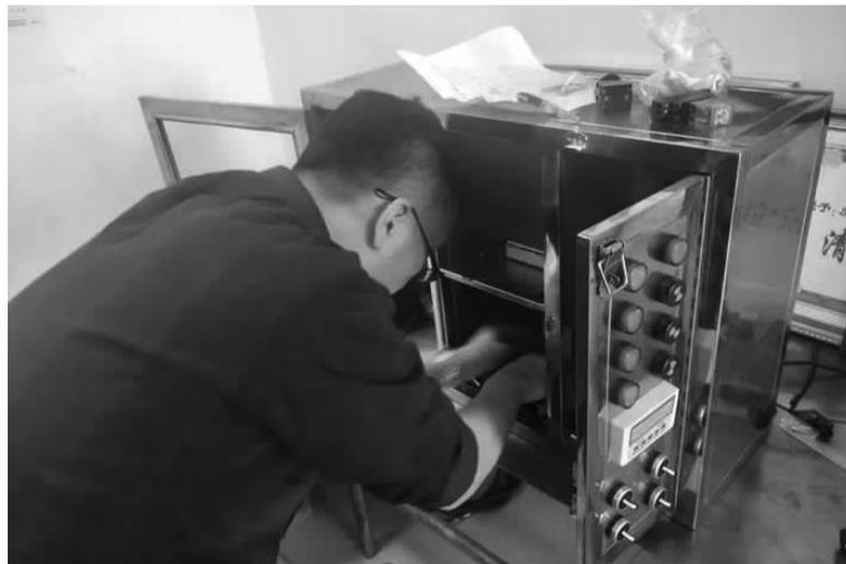
测试、烟雾测试三部分组成。电控部分主要包含空开、变压器220V/12V及220V/24V、旋钮开关、船型开关、送电指示灯、蜂鸣报警器、电源线、信号线、接线插排等元件；烟雾部分主要元件包含风扇换气扇、烟雾装置等配件；温控部分主要利用了温度热源、温度控制仪器等。
