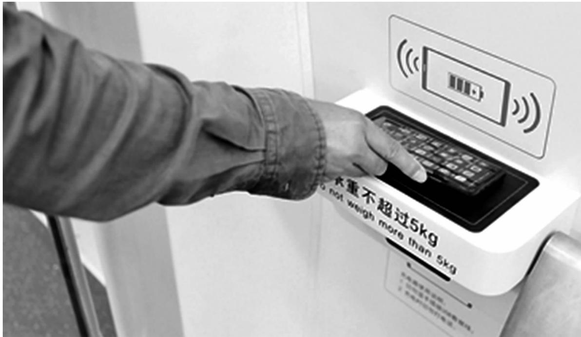
深圳地铁6号线支线车厢内的手机无线充电设施。 资料图片
