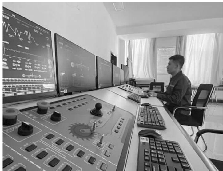
际需求智能调控。智能通风系统搭载的传感器、摄像机能自动采集风量数据,实现了矿井通风地面远程实时监测控制、应急救援时自动调控风流等智能化作业。
