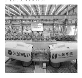
6月7日,全国首个13MW级陆上风电机组全功率试验平台在运达股份北方总部(乌兰察布)智能产业基地首次测试,成功并网。这标志着我国陆上风电机组研发验证正式步入10.X(10-11MW)时代,开启了我国10.5kV中压双馈机组高质量发展的新篇章。
