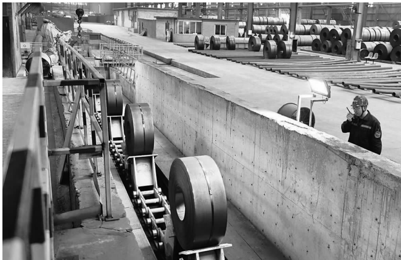
近日,稷山县铭福钢铁制品有限公司工人在检查带钢生产线运行情况。山西省稷山县铭福钢铁制品有限公司新建年产140万吨优特钢项目,采用安全可靠、技术先进、运行费用低的技术工艺,产品涵盖优质碳素结构钢、低合金高强度结构钢等多品种钢材,实现不同规格、不同品种的全覆盖,延长了产业链条。 栗卢建摄
