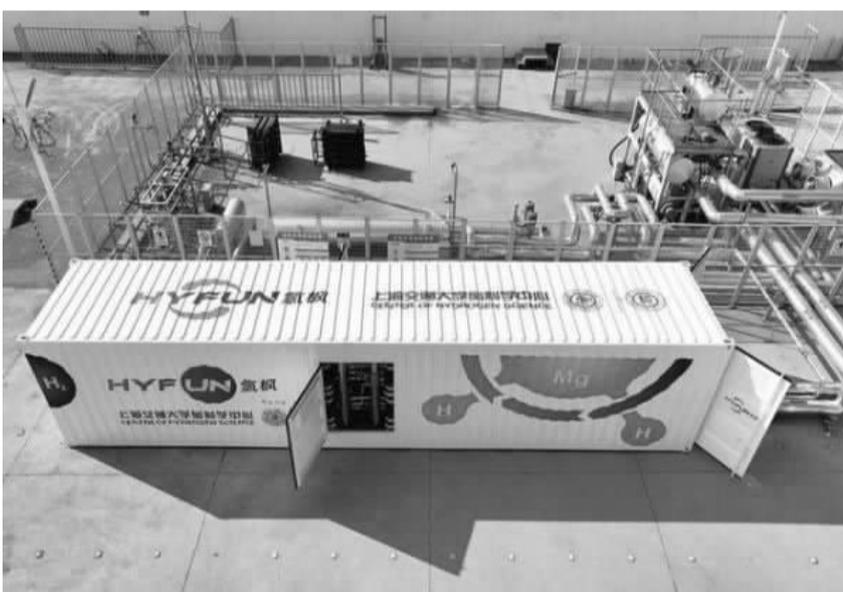
吨级镁基固态储运车在江苏如皋测试基地测试充放氢性能。资料图片
