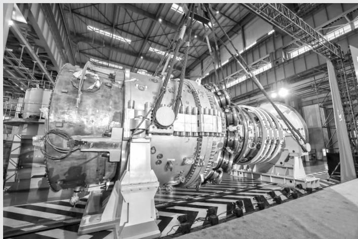
10月7日,我国自主研制的300兆瓦级F级重型燃气轮机在上海临港首次点火成功。
