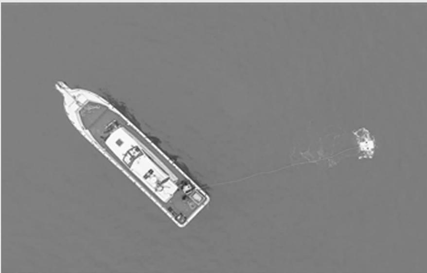
日前,国网山东省青岛市黄岛区供电公司应用海底机器人巡检海底电缆,为灵山岛居民冬季稳定用电提供保障。
