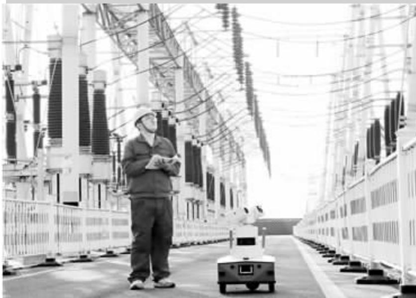
近日,笔者在山西省阳泉市220千伏红卫变电站内看到,搭载着红外热成像仪的智能巡检机器人,沿着运维人员提前设定好的巡检路线进行定点巡检。这些机器人行动自如地经过一个个设备间隔,采集温度、压力等重要参数,为春检工作顺利推进提供有力支持。
