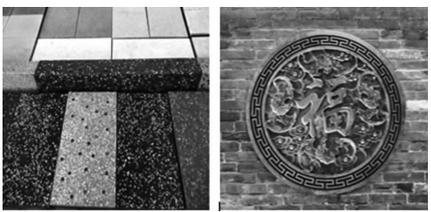
主要生产仿石材PC产品,有仿花岗岩路侧石、仿大理石板、仿古砖瓦等100多种高强度系列产品。生产工艺:湿法工艺采用静压大压力压制成型;外观区别:湿法砖密实,无任何孔洞,可达到天然石材效果;实用型区分:湿法PC砖密度高,不透水,具有天然石材外观,装饰效果好,广泛应用于室内通道,如高铁、地铁站台等场景,强度高且使用寿命长。
