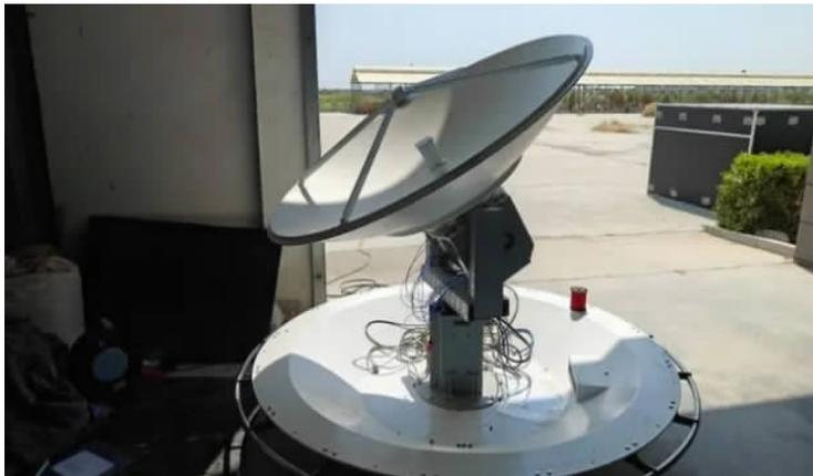
正在调试的缩比高分辨全极化昆虫雷达,随后将运至外地安装。
