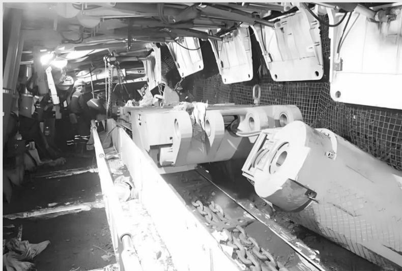
近日,青海能源集团鱼卡公司 1179 智能化工作面采购的采煤机到货后,为保证采煤机在井下顺利安装,鱼卡公司相关部门设备管理人员和厂家技术人员第一时间对采煤机进行组装、调试,并对调试完毕的采煤机进行了拆解、装车,然后运输到 1179 工作面进行安装。在此期间,出现的一些技术问题由厂家技术人员给出了相应的解决方案及详细解答。据悉,该采煤机比普通采煤机增加了姿态感知、视频监控、交互通信、记忆截割、自主定位、煤岩识别等功能。
