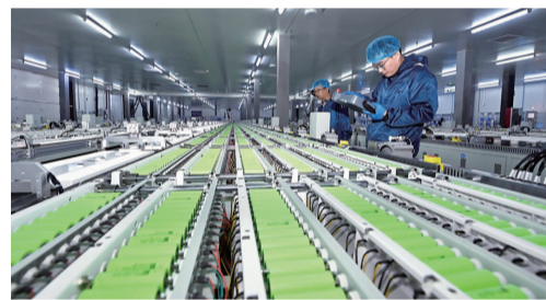
▲ 华阳集团华钠芯能电芯制造中心职工正在进行电芯化作业
